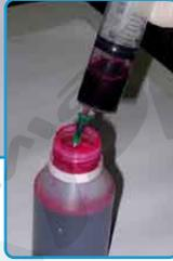
**PASO 02** Cargar el cartucho con tinta por el orificio que **NO** dice "air".
