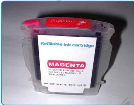
**PASO 04** Colocar los cartuchos en la impresora. **El orificio que dice "air" DEJARLO DESTAPADO.** Así Ya podrá imprimir.
