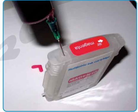
**PASO 03** Ya con tinta, tapan el orificio por donde se cargo tinta, y el de aire dejarlo destapado.
